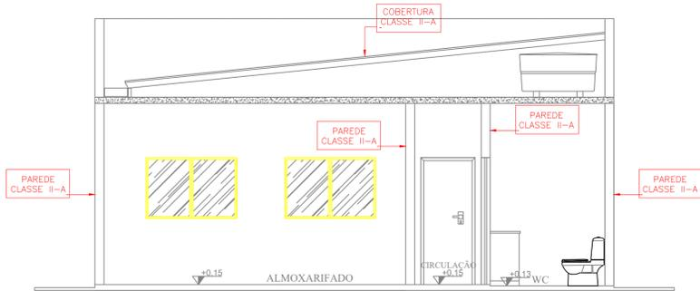
CORTE A-A - CONTROL DE MATERIALS DE ACABAMENTO E REVESTIMENTO
