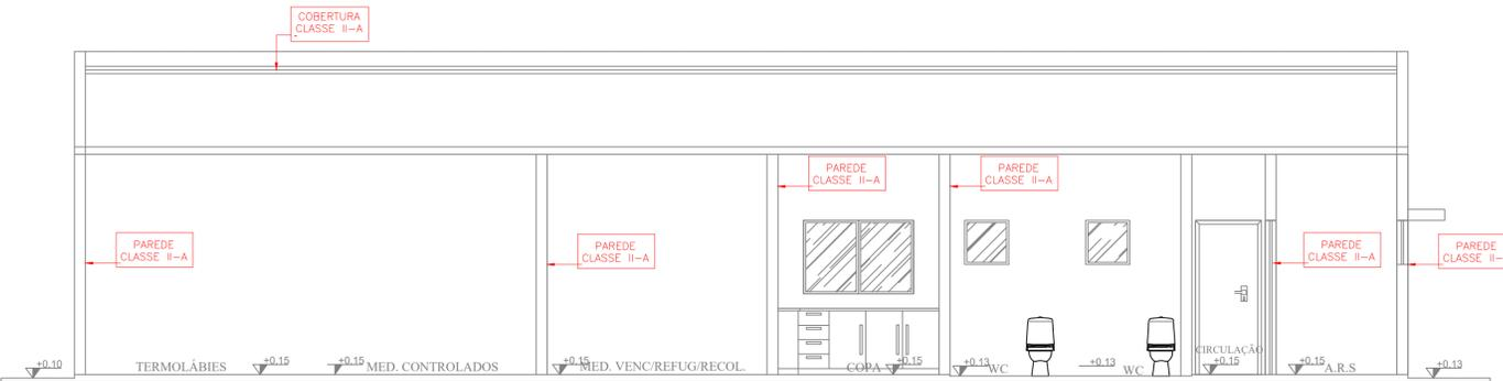
CORTE B-B - CONTROL DE MATERIALS DE ACABAMENTO E REVESTIMENTO
